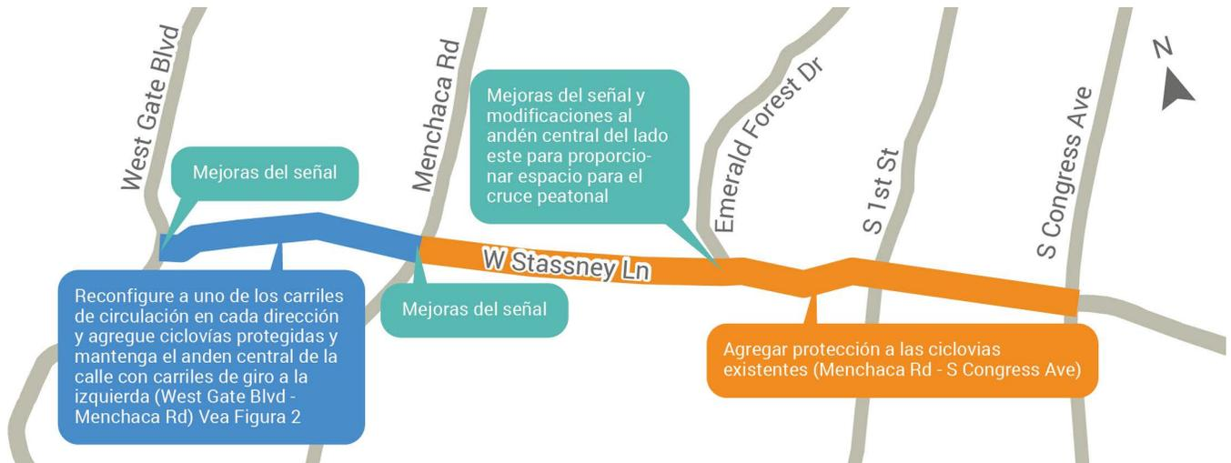
Figura 2 - Cambios propuestos a la sección transversal típica para Stassney Lane desde West Gate Boulevard hasta Menchaca Road
