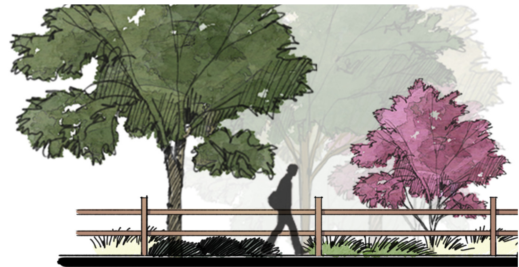
ELEVATION - Split Rail Barrier Fence Option (N.T.S.)
